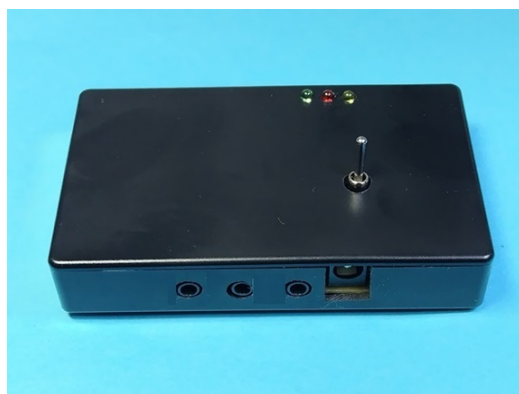
タカチ電機製プラスチックケースSW-95に格納例
