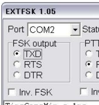
(6)FSK出力を行うには、オプション→設定画面→その他を選択すると下記画面となりますので、送信ポートをサウンド+COM-TxD(FSK)に設定しOKをクリックします。
